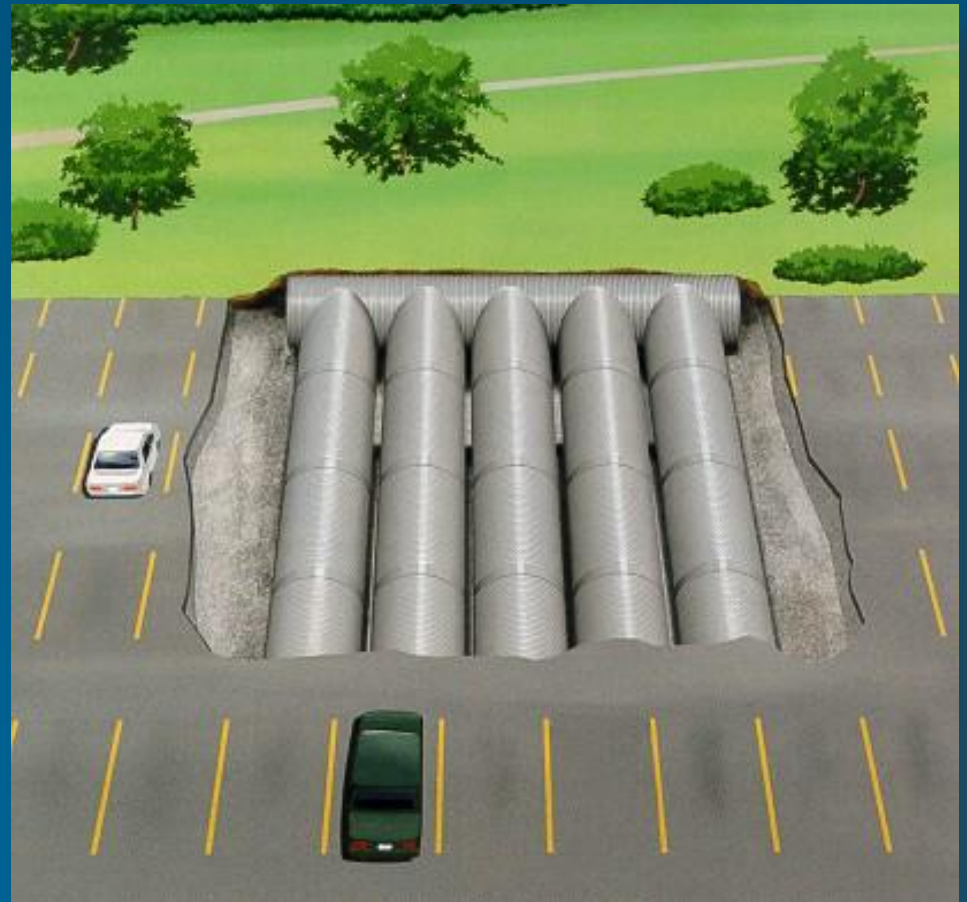
Reservatório de detenção
