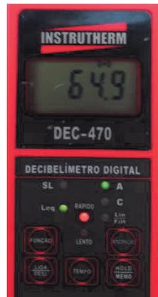
**FOTO Nº 13:** Foto mostrando a primeira medição de **LAeq = 64,9 dB(A)** realizada no no **PONTO 03**, durante a vistoria de 23/10/2020, no período das 7h às 19h.
