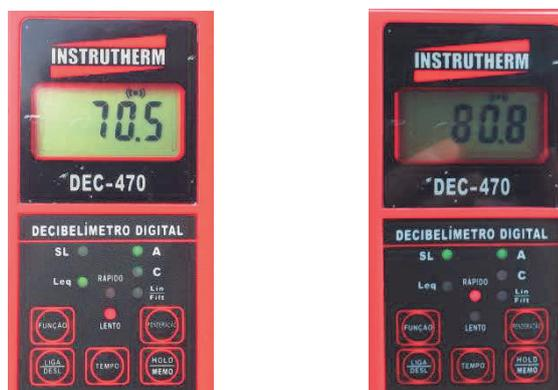
**FOTO Nº 19 (a,b):** Mostrando a terceira medição de  $L_{Aeq} = 70,5 \text{ dB(A)}$ , atingindo picos de  $80,8 \text{ dB(A)}$ , realizada no **PONTO 04**, durante a vistoria de 27/10/2020, no período das 22h às 7h.
