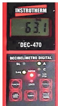
**FOTO Nº 14:** Foto mostrando a segunda medição de **LAeq = 63,1 dB(A)** realizada no **PONTO 03**, durante a vistoria de 23/10/2020, no período das 19h às 22h.
