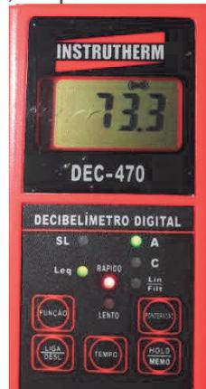
FOTO Nº 26: Mostrando a segunda medição de  $LAeq = 73,3 \text{ dB(A)}$ , realizada no **PONTO 06**, durante a vistoria de 23/10/2020, no período das 19h às 22h.
