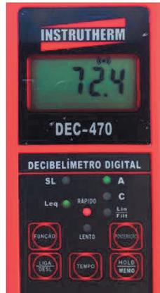
FOTO Nº 25: Mostrando a primeira medição de  $LAeq = 72,4 \text{ dB(A)}$ , realizada no **PONTO 06**, durante a vistoria de 23/10/2020, no período das 7h às 19h.
