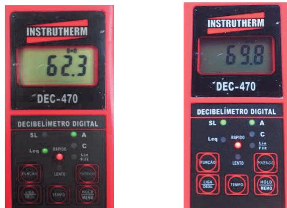
**FOTO Nº 15 (a,b):** Foto mostrando a terceira medição de **LAeq = 62,3 dB(A)** realizada no **PONTO 03**, atingindo picos de **69,8 dB(A)**, durante a vistoria de 27/10/2020, no período das 22h às 7h.
