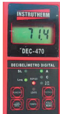
**FOTO Nº 17:** Mostrando a primeira medição variando de  $L_{Aeq} = 71,4 \text{ dB(A)}$ , realizada no **PONTO 04**, durante a vistoria de 23/10/2020, no período das 7h às 19h.
