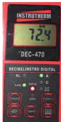
**FOTO Nº 18:** Mostrando a segunda medição de  $L_{Aeq} = 72,4 \text{ dB(A)}$ , realizada no **PONTO 04**, durante a vistoria de 23/10/2020, no período das 19h às 22h.
