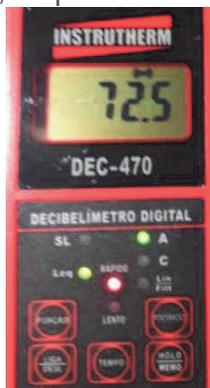
**FOTO Nº 22:** Mostrando a segunda medição de  $LA_{eq} = 72,5 \text{ dB(A)}$ , realizada no **PONTO 05**, durante a vistoria de 23/10/2020, no período das 19h às 22h.
