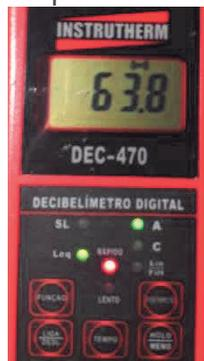
FOTO Nº 38: Mostrando a segunda medição de **LAeq = 63,8 dB(A)**, realizada no **PONTO 09**, durante a vistoria de 23/10/2020, no período das 19h às 22h.
