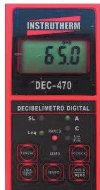
FOTO Nº 09: Foto mostrando a primeira medição realizada no PONTO 02, com valores de  $L_{Aeq} = 65,0 \text{ dB(A)}$ , durante a vistoria de 23/10/2020, no período das 7h às 19h.
