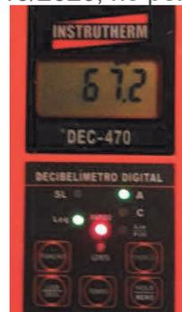
FOTO Nº 30: Mostrando a segunda medição de **LAeq = 67,2 dB(A)**, realizada no **PONTO 07**, durante a vistoria de 23/10/2020, no período das 19h às 22h.
