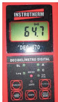
FOTO Nº 06: Foto mostrando a segunda medição de **LAeq = 64,7 dB(A)** realizada no **PONTO 01**, durante a vistoria de 23/10/2020, no período das 19h às 22h.
