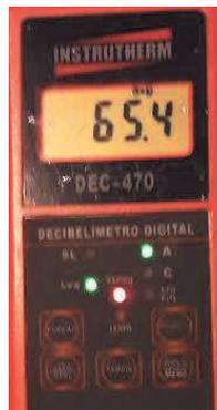
FOTO Nº 10: Foto mostrando a segunda medição de  $L_{Aeq} = 65,4 \text{ dB(A)}$ , realizada no PONTO 02, durante a vistoria de 23/10/2020, no período das 19h às 22h.
