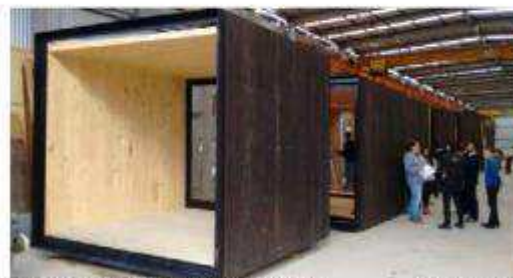
Produção industrial dos módulos prontos em CLT
