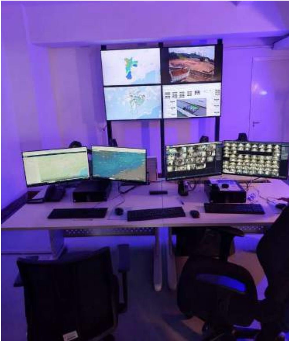
Figura 17 CCO Telemonitoramento e Videomonitoramento com destaque para o videowall.
