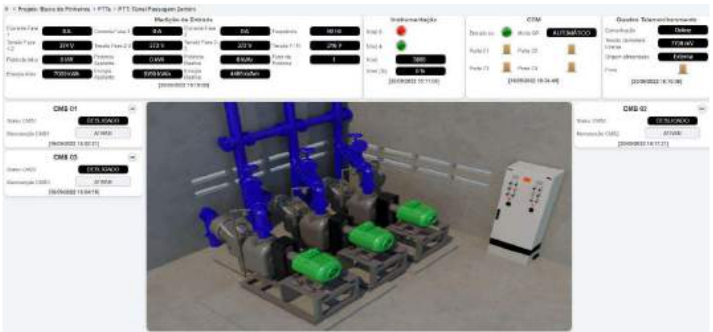
Figura 15 Tela de monitoramento das bombas
