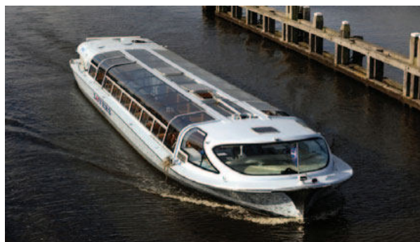
Figura 6.3 – Embarcação autopropelida Nemo H2 utilizada nos canais de Amsterdã e Barco Urbano de Carga autopropelido. Fonte: GMF, 2011.
