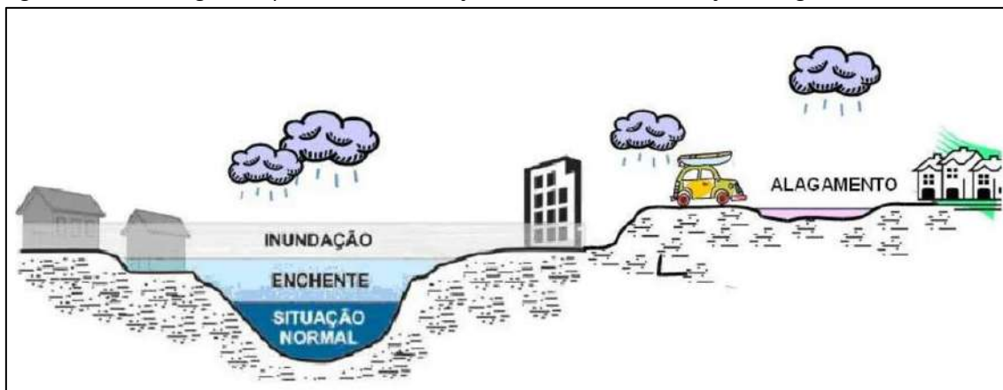
Figura 41 – Modelo gráfico que ilustra a diferença entre enchente, inundação e alagamento
