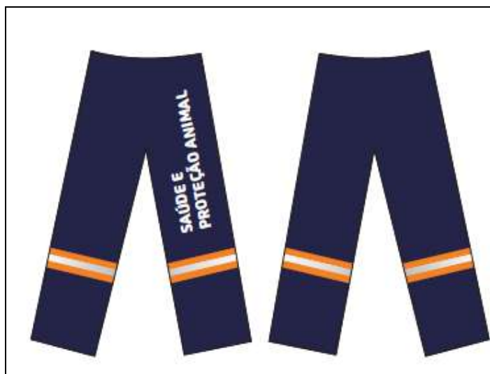
Figura 6 – Modelo Ilustrativo da calça operacional unissex, com indicação da aplicação da logomarca de identidade visual (estampa) e faixa retroreflexivas de segurança.
