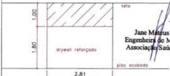
VISTA: DIVISÃO DRYWALL S/ ESCALA
