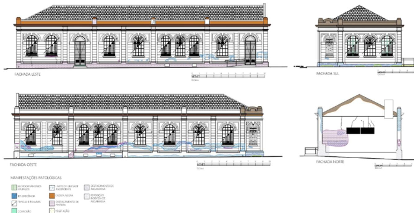
metro da edificação, substituição do reboco e pintura das paredes internas, restauro da fachada e esquadrias. O objetivo dessa intervenção é facilitar o escoamento da água por meio de sistemas de canaletas, direcionando para longe das paredes e prevenindo o acúmulo de água na fundação do Anexo, o que tem agravado o problema da infiltração ascendente; além disso, restabelecer a “transpiração” das paredes, com uso de reboco e tinta mineral (à base de cal).
