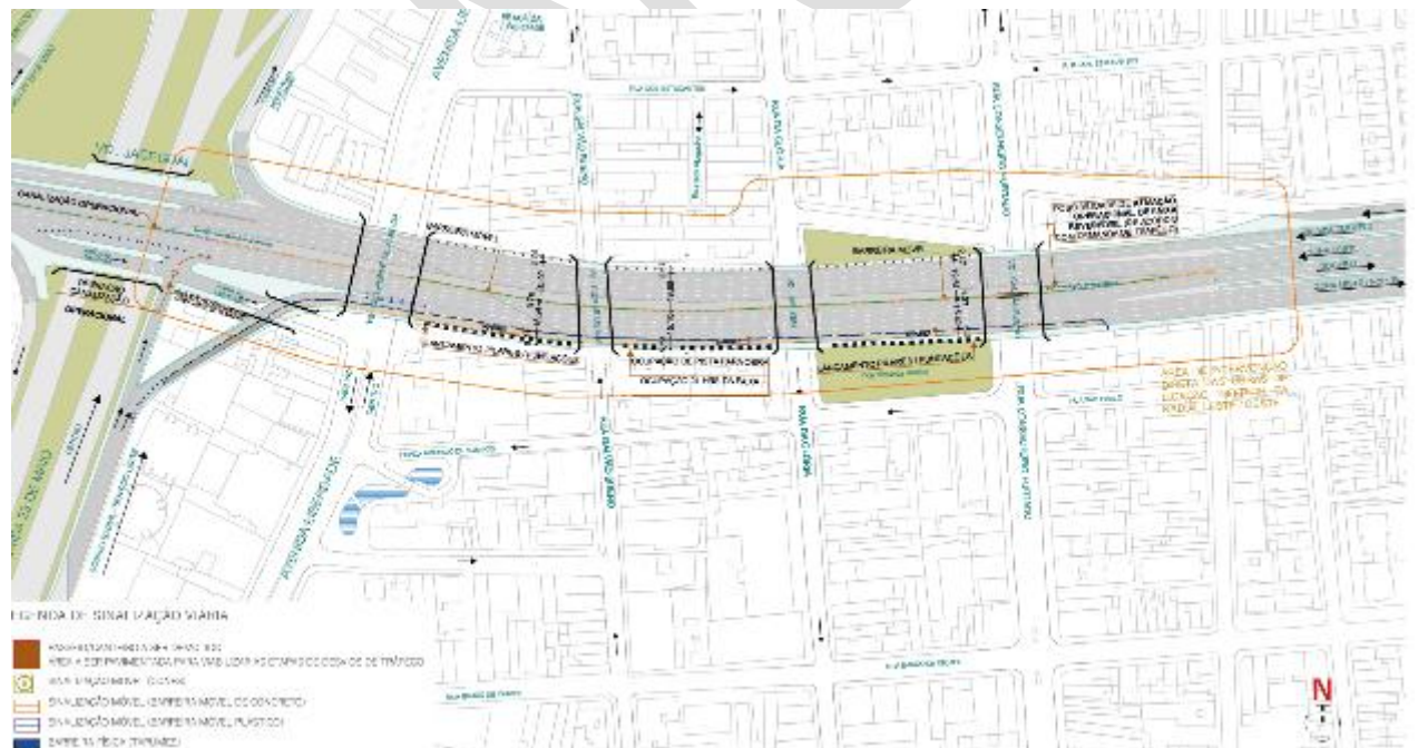
Figura 47 - Interrupções e sinalizações durante a implantação das fundações e pilares da extremidade sul
