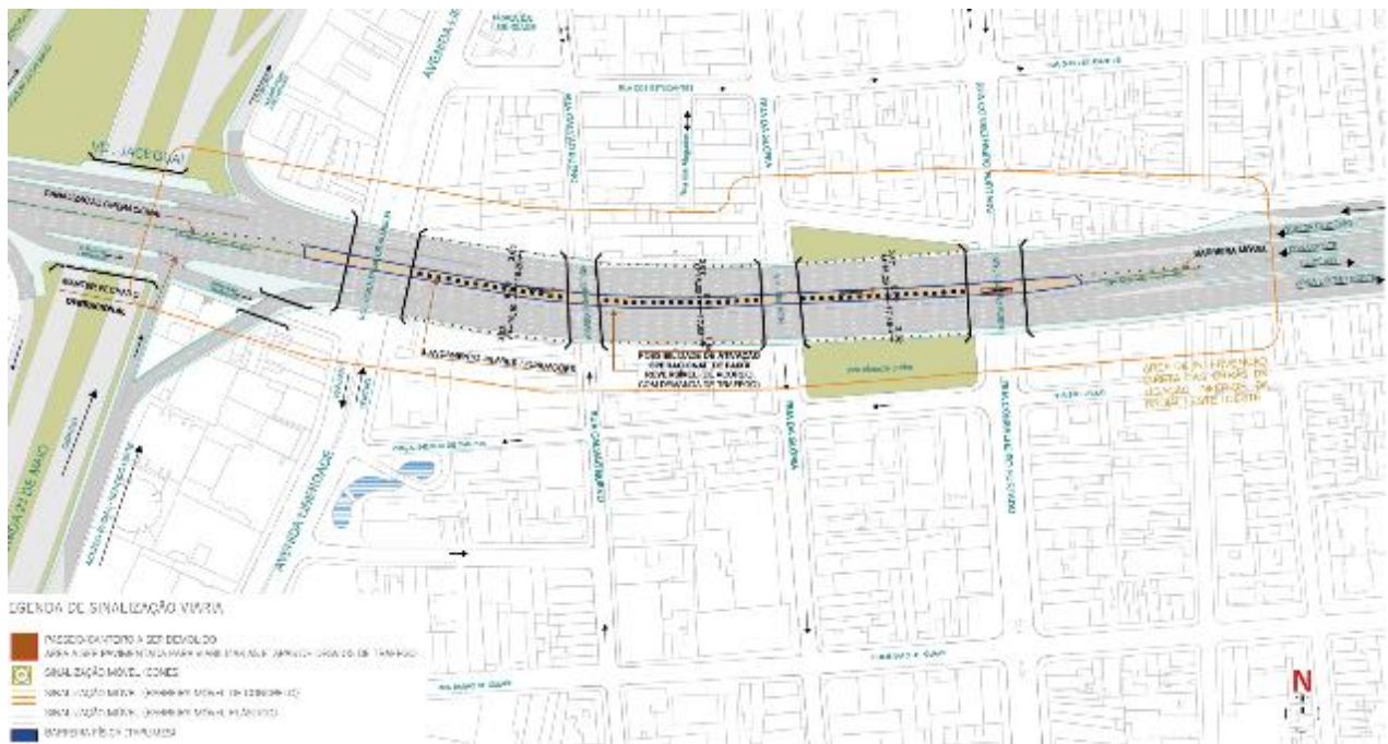
Figura 48 - Interrupções e sinalizações durante a implantação das fundações e pilares centrais
