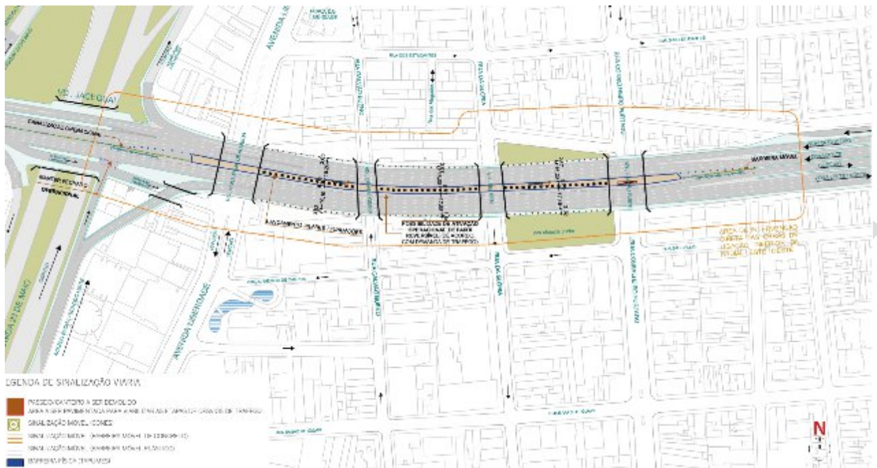
Figura 48 - Interrupções e sinalizações durante a implantação das fundações e pilares centrais
