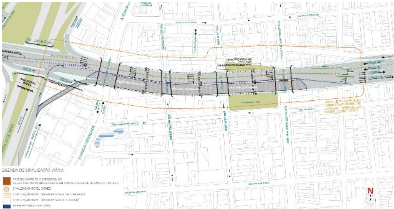
Figura 49 - Interrupções e sinalizações durante a implantação das vigas na faixa sul
