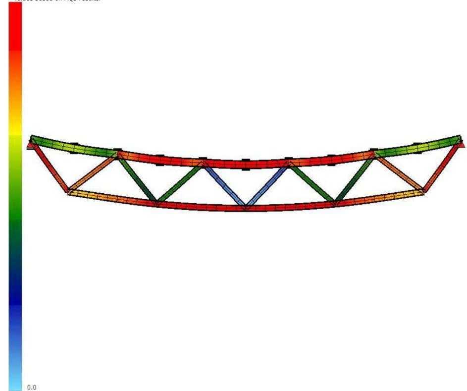
Tensões de Von Mises com deflexão de 20x sob a combinação crítica LC
