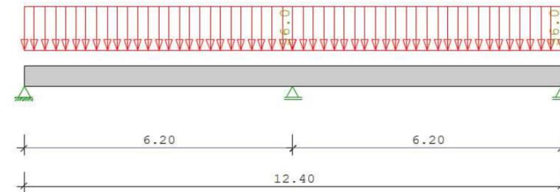
Steel girder over 2 Spans S355 DIN EN 1993-1-1/NA:2015-08
