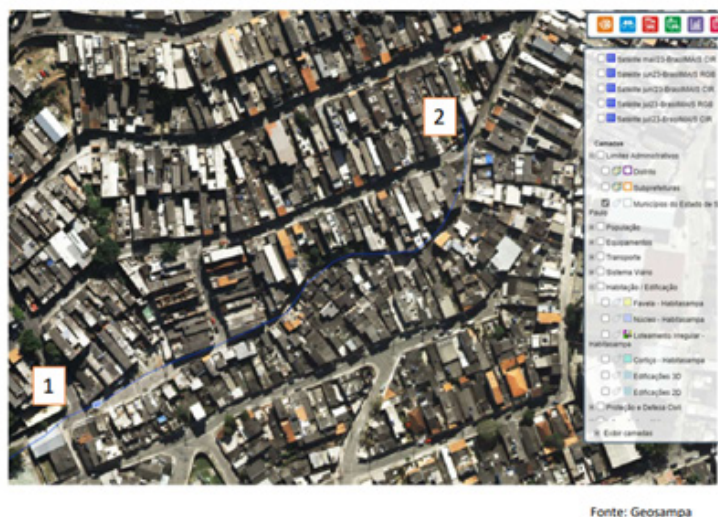
Imagem 6: Exemplo ilustrativo de um córrego canalizado fechado identificado no Geosampa e confirmado em vistoria. Portanto, não há incidência de APP, houve perda da função ambiental.
