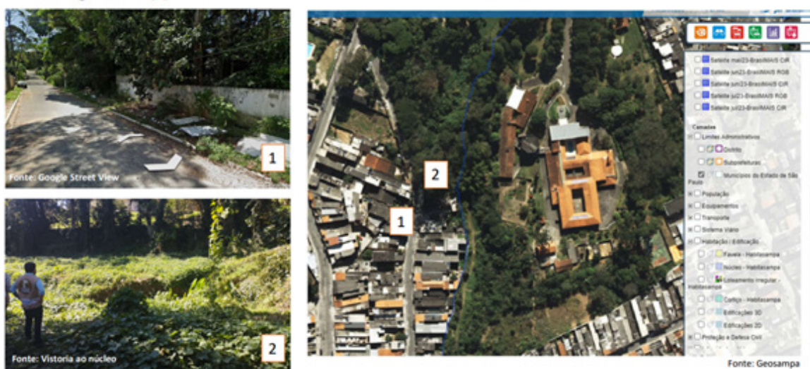
Imagem 2: Exemplo ilustrativo de um córrego natural e aberto identificado no Geosampa e confirmado em vistoria. Portanto, há incidência de APP.
