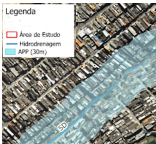
Imagem 5: Exemplo ilustrativo da projeção da faixa de APP em um córrego canalizado e aberto identificado no Geosampa e confirmado em vistoria.
