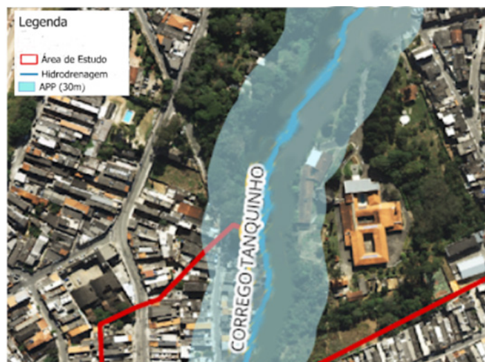
Imagem 3: Exemplo ilustrativo da projeção da faixa de APP em um córrego natural e aberto identificado no Geosampa e confirmado em vistoria.
