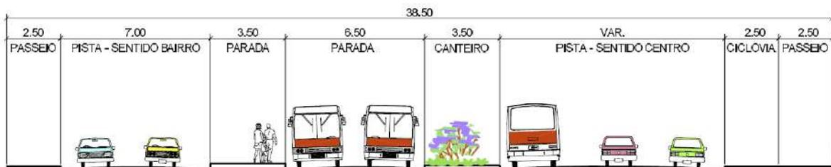
**Figura 2.7.2-1** – Seção com paradas com área para ultrapassagem.
