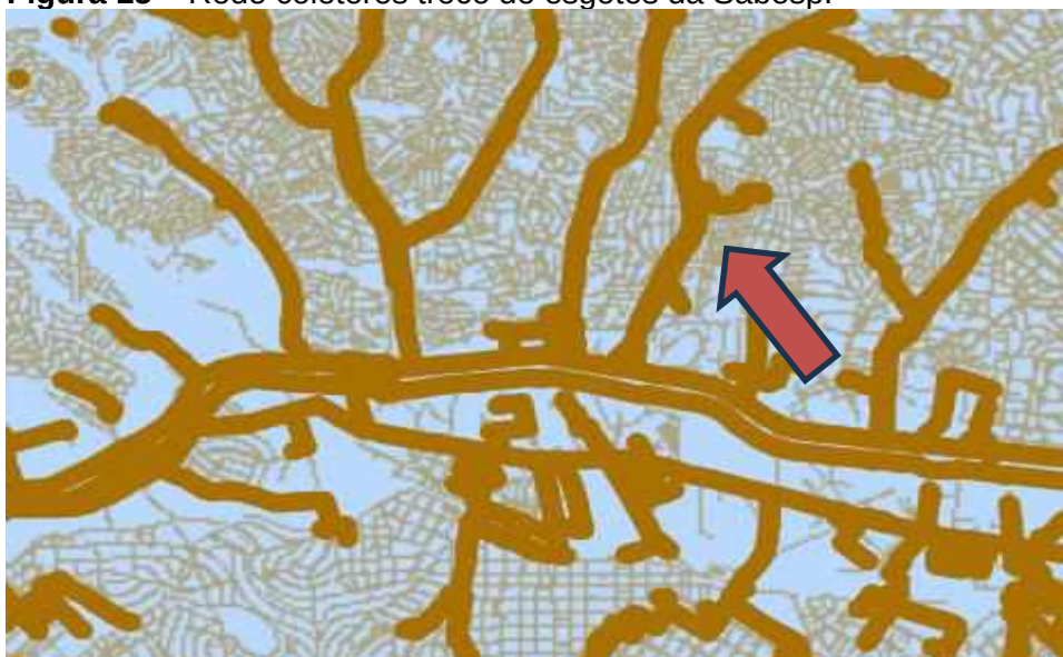
Figura 15 – Rede coletores troco de esgotos da Sabesp.
