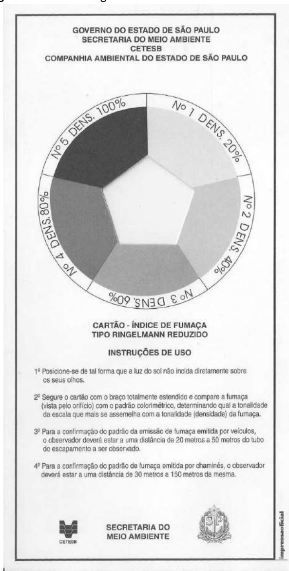
Figura 62 - Escala Ringelmann Reduzida – Frente
