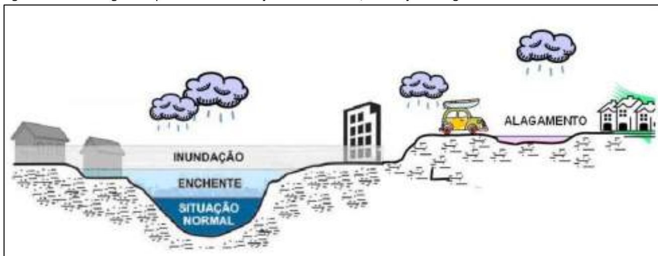
Figura 39 – Modelo gráfico que ilustra a diferença entre enchente, inundação e alagamento
