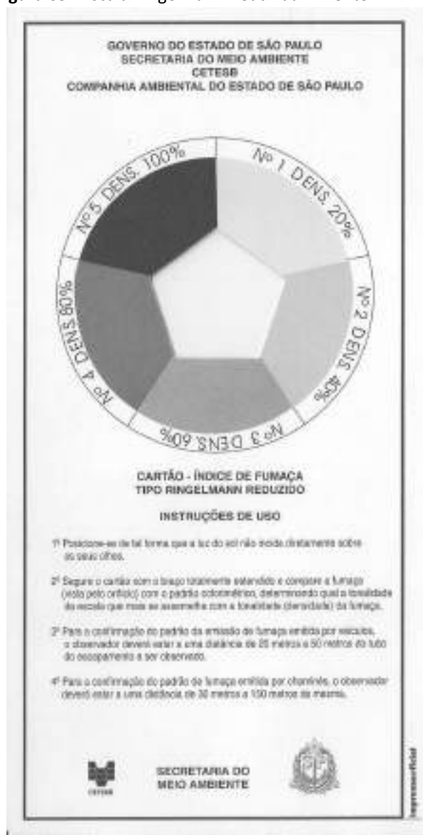
Figura 65 - Escala Ringelmann Reduzida – Frente
