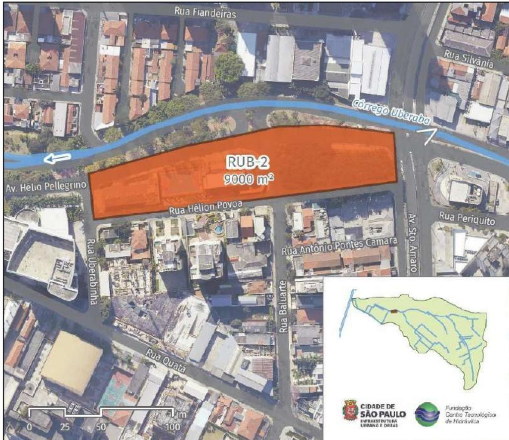
Figura 5.2 - Indicação da posição do reservatório RUB-2 na área do Parque (Fonte: FCTH, 2016).
