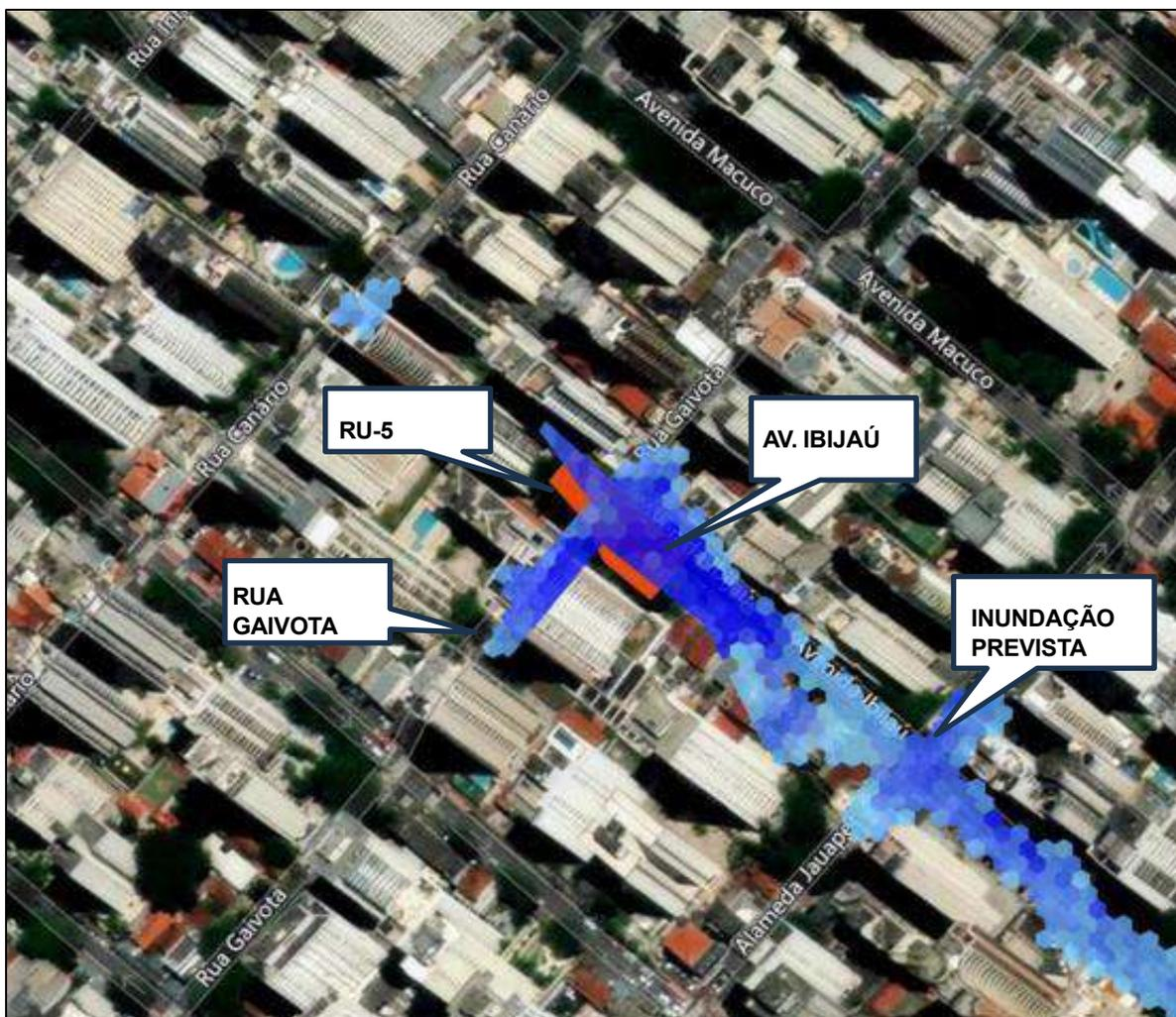
**FIGURA 2.6 – MANCHA DE INUNDAÇÃO APÓS IMPLANTAÇÃO DO RESERVATÓRIO RU-5 SEM QUE O RESERVATÓRIO RUN-2 ESTEJA IMPLANTADO. (FONTE: FCTH, 2023).**
