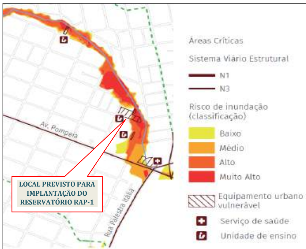
Figura 4.3 – Áreas críticas suscetíveis às inundações na bacia do Córrego Água Preta (FCTH,2019).
