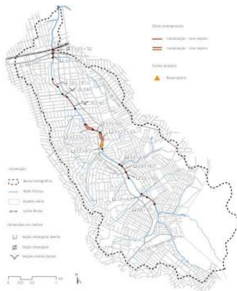
Figura 22 - Localização das obras emergenciais no ribeirão Lajeado. Fonte: FCTH-SIURB-2024.
