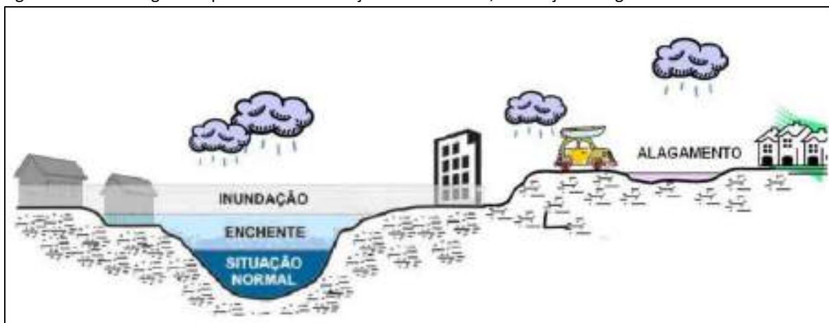
Figura 42 – Modelo gráfico que ilustra a diferença entre enchente, inundação e alagamento
