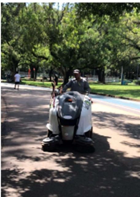
**Figura 91 Varredeira aspiradora em operação**
