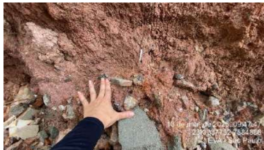
Figura 134- PED03 - Fragmentos de rocha angulosos em matriz argilosa
