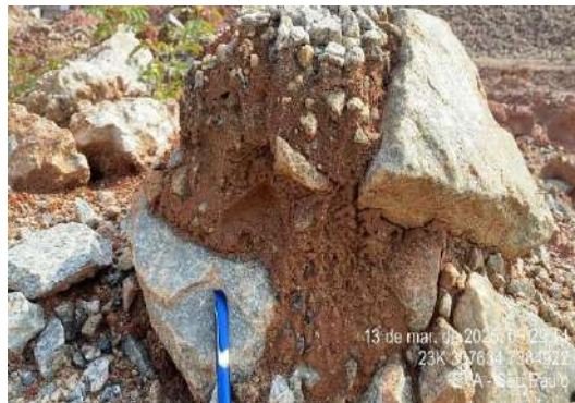
Figura 128- PED02 - Contato abrupto entre o regolito e rocha fraturada, com presença de blocos angulosos imersos em matriz argilosa.
