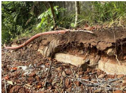
Figura 121- PED01B - Horizonte B textural com nítida transição em contato com camada com resíduos de ação antrópica – destaque para resíduos de plástico e tubulações.
