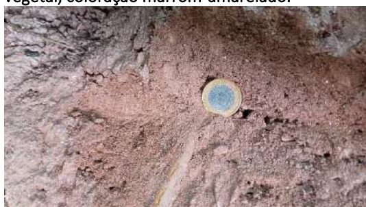
Figura 151- PED07 [-23.636697, 46.590287] – Solo argiloso, coloração vermelho-amarronzada, presença de material reutilizado
