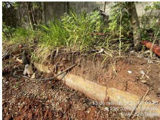
Figura 122- PED01B - Horizonte B textural com nítida transição em contato com camada com resíduos de ação antrópica – destaque para resíduos de plástico e tubulações.
