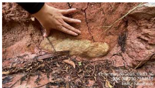
Figura 138- PED04 - Matacão imerso em solo argiloso.
