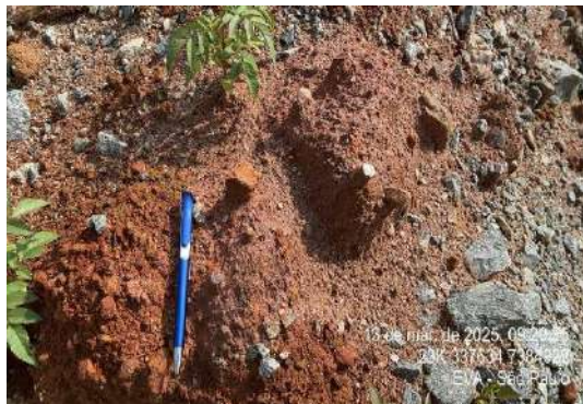
Figura 127- PED02 - Blocos de solo com estrutura granular média, coloração vermelho-amarelada e presença de fragmentos litológicos angulosos em matriz argilosa, indicativos de Argissolo com horizonte B textural.
