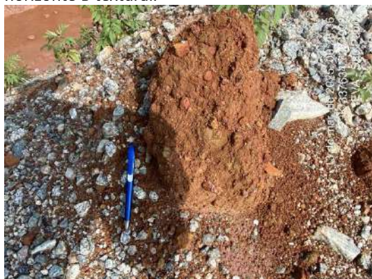
Figura 129- PED02 -23.638214, 46.591786 - Fragmento de horizonte B latossólico exposto com estrutura granular e coloração vermelho-escura, material argiloso intemperizado e presença de concreções ferruginosas em ambiente próximo à drenagem.
