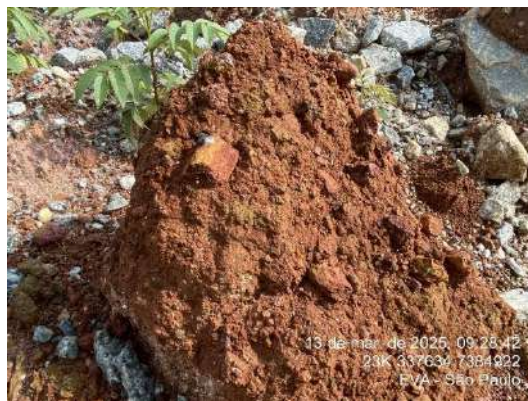
Figura 130- PED02 – Detalhamento do fragmento de horizonte B latossólico exposto com estrutura granular e coloração vermelho-escura
