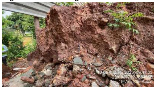
Figura 136- PED03 - Talude escavado mostrando solo vermelho escuro e clastos.
