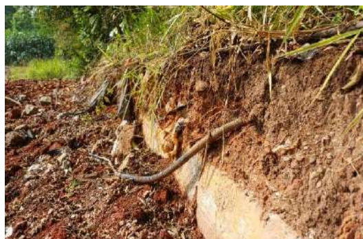
Figura 120- PED01 [-23.638108, 46.592195] - Horizonte B textural com nítida transição em contato com camada com resíduos de ação antrópica– destaque para resíduos de plástico e tubulações.
