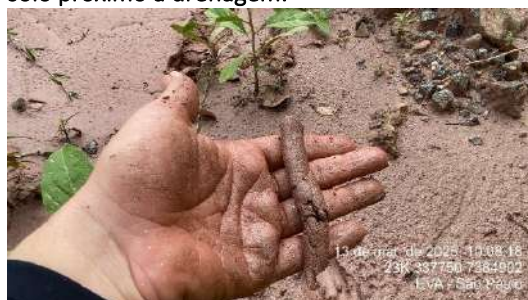
Figura 144- PED05 – Solo silto-argiloso com moderada plasticidade.
