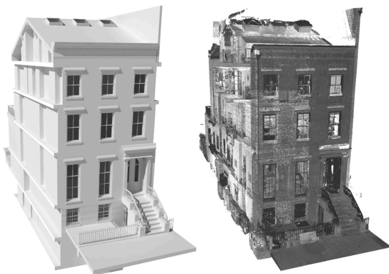
Figura 1 – Modelo de malha geométrica (esq.) e modelo de nuvem de pontos (dir.).
