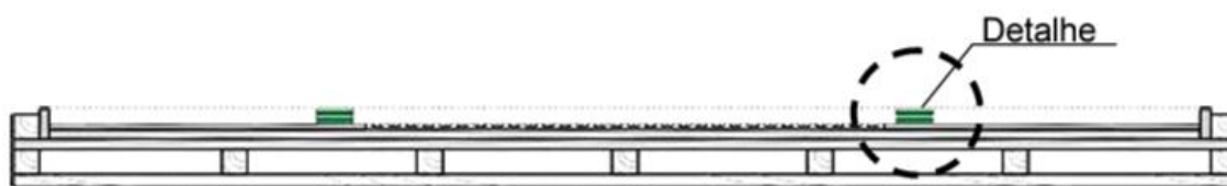
Figura 6 – Corte esquemático de fôrma de madeira para peças especiais
