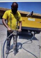
Martelete de 15 a 30 kg é alimentado através de ar comprimido.
