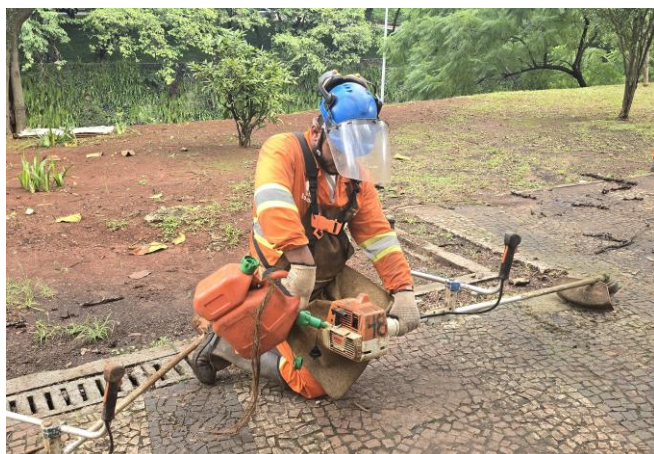
Foto 02. Operador de Roçadeira abastecendo a roçadeira com a mistura de gasolina e óleo 2T
